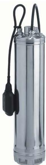
La gamme des pompe de puits ES bénéficie des dernières avancées technologiques et du savoir faire reconnu de FRANKLIN ELECTRIC. Le moteur est encapsulé, protégé par une étanchéité avec double garniture mécanique et toutes les pièces en contact avec le fluide sont en inox.
